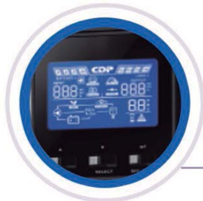
Panel LCD con rotación de 90°
